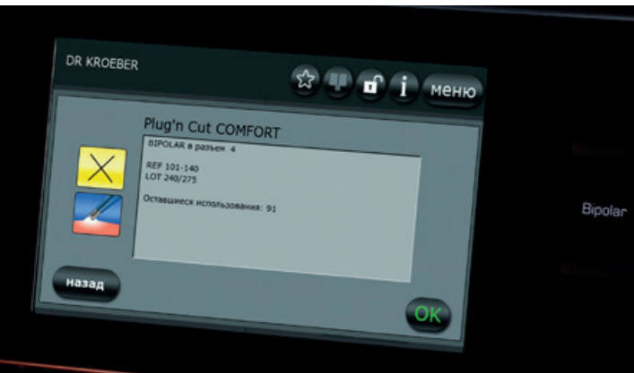
Plug'n Cut COMFORT: система COMFORT автоматически распознает инструмент COMFORT, информирует о количестве применений и выбирает параметры, необходимые для цели применения
